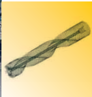
FEM Calcul par éléments finis: Analyse détaillée des propriétés physiques d'un outil dès son lancement.
